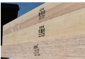
▲提供された部材(根羽村のスギ、川上村のカラマツ、天龍村のヒノキ)
