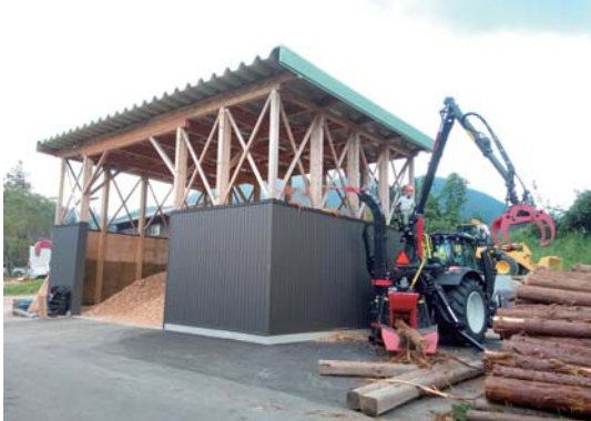
▲農業用トラクターベースの移動式チッパー 素材生産現場でのチップ製造も可能
